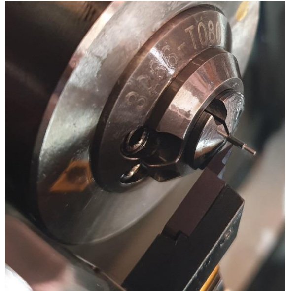
Oberflächenrauigkeiten von Rz 1 bis 1,7 für Teile in einem Durchmesserbereich zwischen 1 und 30 mm
