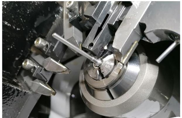
*Das System LWP im Einsatz bei Brasseler zur Produktion von Konturen ohne Übergangsradien*
