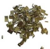
Späne ohne DAK-..B oben und mit DAK-..B unten
